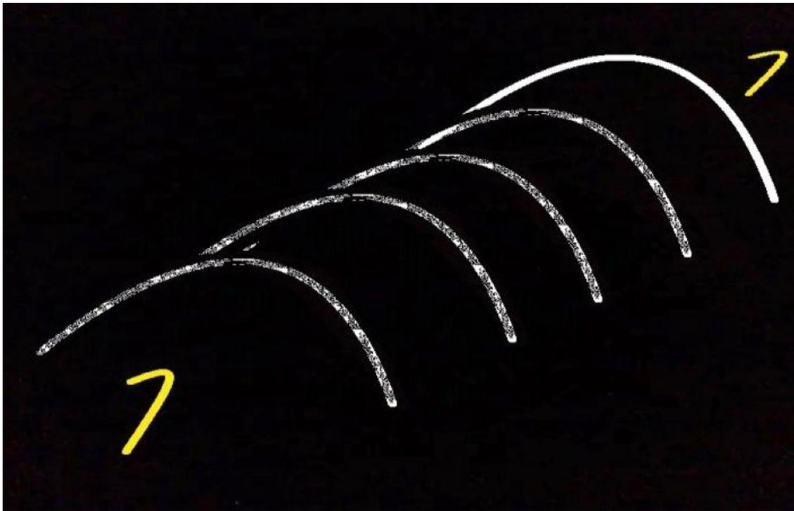
Pueden verse en el dibujo de arriba, en blanco los arcos, en amarillo los anclajes de hierro con forma de gancho que tendrán que ser clavos, uno en cada extremo del microtunel.
