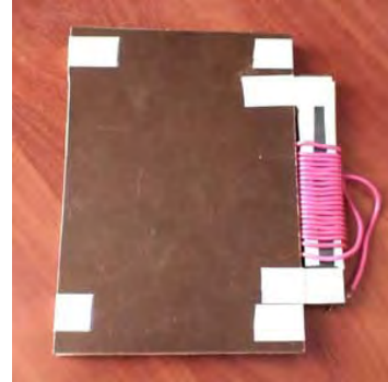
TRANSFORMADOR DE PROTOTIPO:
